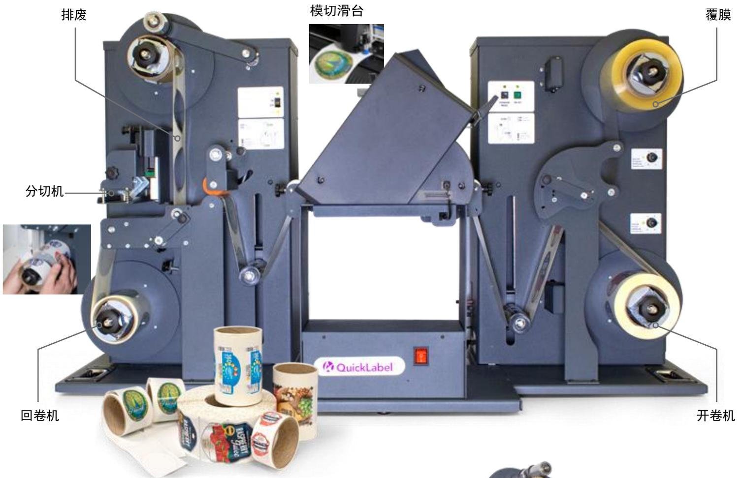
**LF-100 与 LF-200 数码模切机**是一款专业级、设计紧凑、多功能一体化的桌面印后加工系统，使标签模切、覆膜一次成型。
